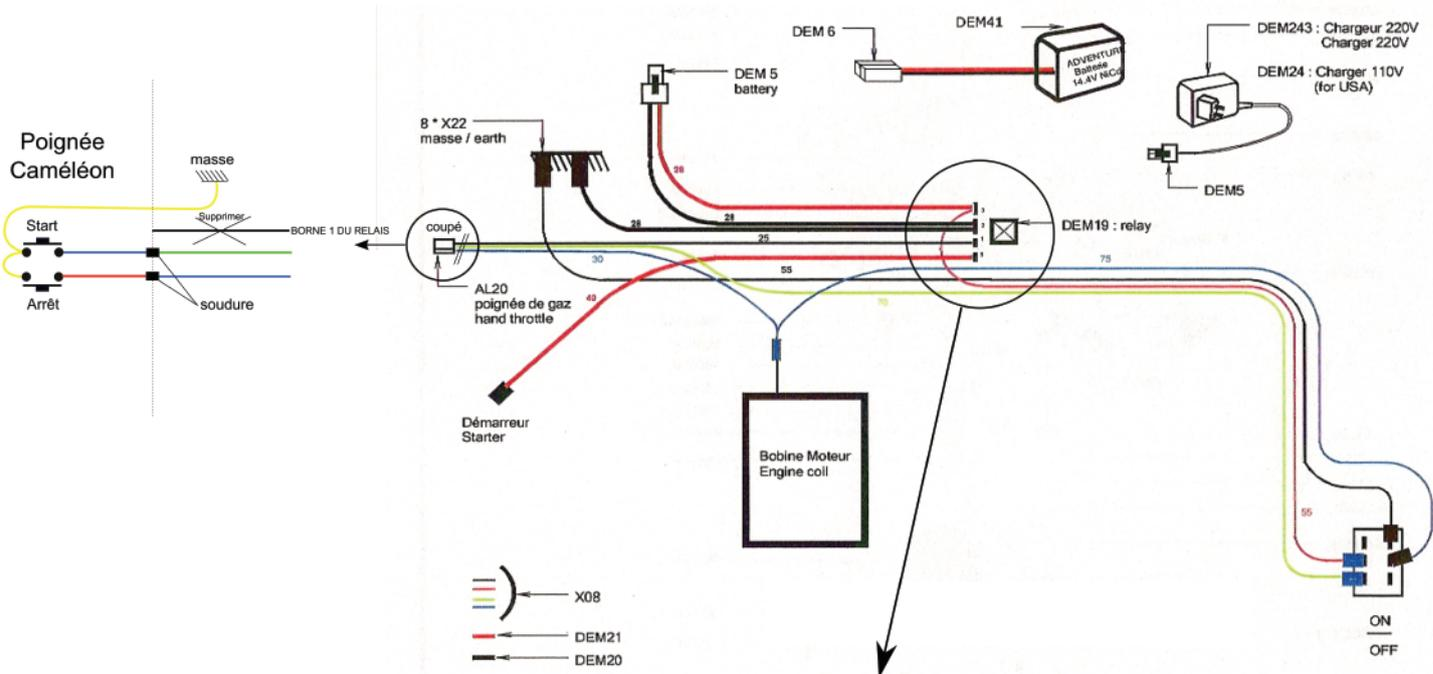
1) Dessouder le groupe de fils noir et laisser-les souder entre eux. Isoler la soudure avec de la gaine thérorétractable.
